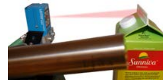
PrintCheck står rett etter merkemaskinen på linja, dette sikrer at man kan reagere raskt ved eventuell feilmerking på produktene.
