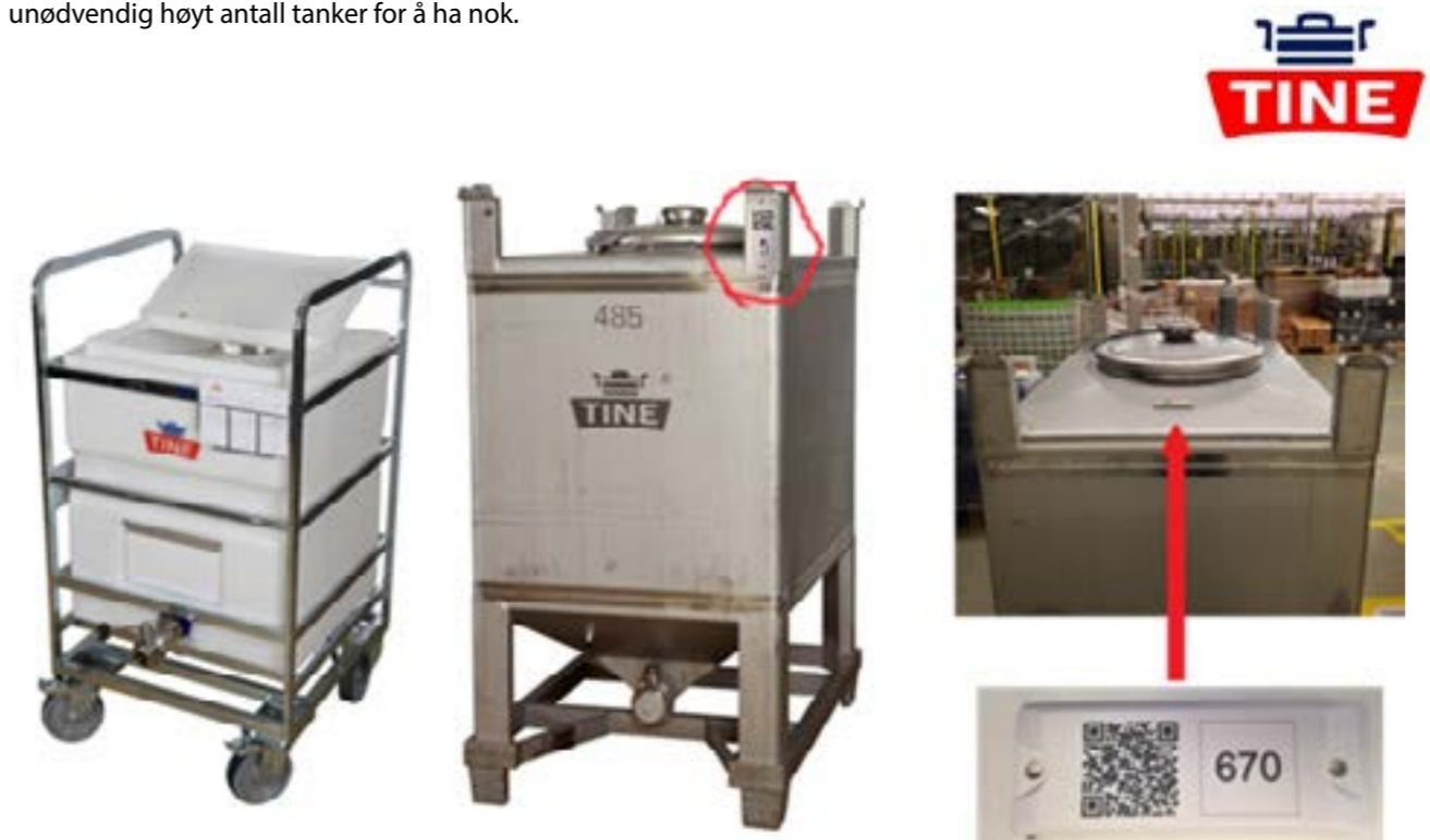
Over: Ved scanning av QR-koden på RFID-taggen kan ting som utlevering registreres og knyttes til person, GPS-posisjon, tank og tidspunkt.
