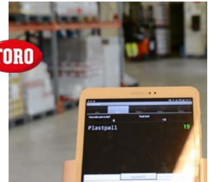
Høyre: Fra lagerkontoret kan man til enhver tid se hvor mange paller som er tatt ut av lager. Tallet oppdateres umiddelbart når trucken passerer RFID-antennen.
