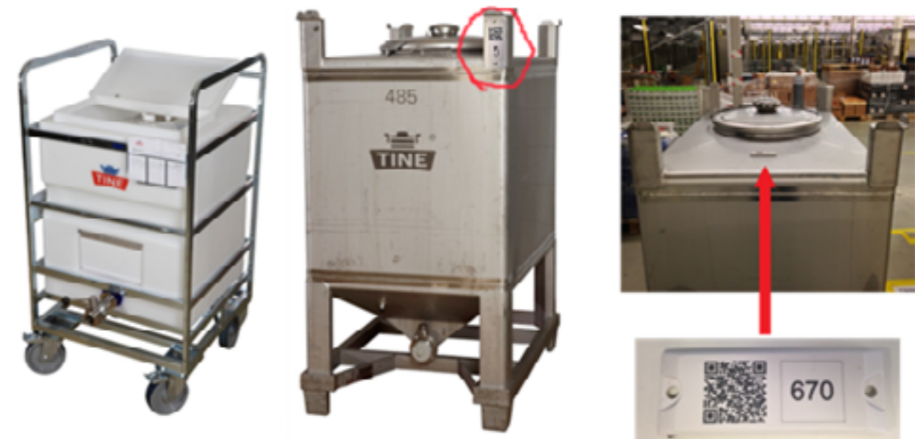
Over: Ved scanning av QR-koden på RFID-taggen kan ting som utlevering registreres og knyttes til person, GPS-posisjon, tank og tidspunkt.
